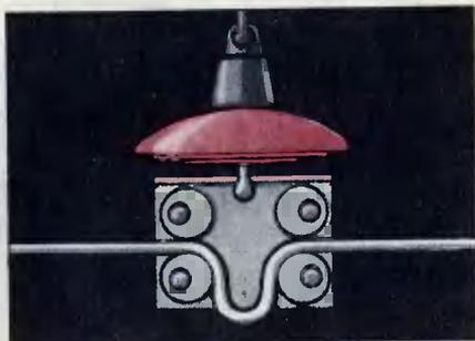
можность натягивать провод в противоположную сторону. Между обеими парами остается петля для нагрузки. Такая система крепления проводов очень экономична и удобна.
